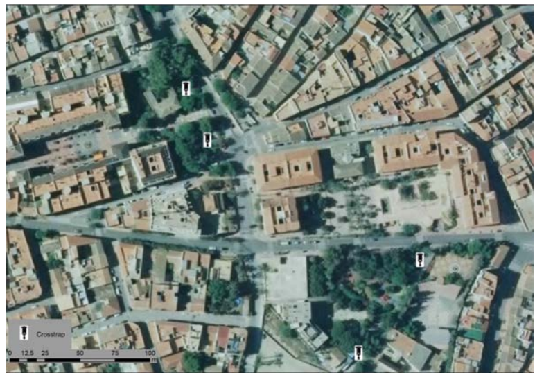
Ejemplo de instalación de trampas para control de T. destruens , en una zona urbana con parques públicos con presencia de pinos (0,8 ha), con 4 trampas instaladas en lugares seleccionados.
